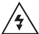
Le symbole de l'éclair avec une pointe de flèche à l'intérieur d'un triangle équilatéral est utilisé afin d'alerter l'utilisateur de la présence d'un «voltage dangereux» non isolé à l'intérieur du produit qui pourrait être suffisant pour constituer un risque de décharge électrique pour les gens.
